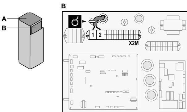
3 Befestigen Sie das Kabel mit Kabelbindern an den Kabelbinderhalterungen.
