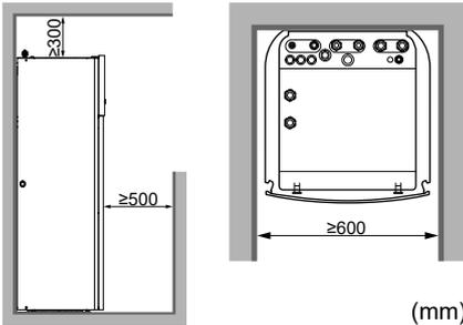
Zusätzlich zu den Vorgaben für die Abstände: Da die Gesamtkältemittelfüllmenge im System  $\geq 1,84$  kg beträgt, muss der Raum, in dem Sie das Innengerät installieren, auch den in "4.1.3 Installationsmuster" [p. 6] beschriebenen Bedingungen entsprechen.
