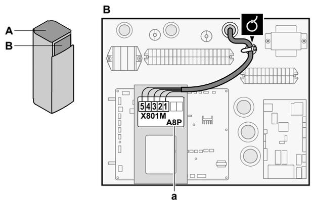
a Die Installation des EKR1AHTA (+ Montageplatte, siehe "6.4 So montieren Sie die Montageplatte" ▶ 28]) ist erforderlich.
